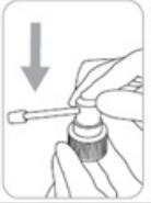
1. Encliqueter la canule dans la pompe : tenir fermement le corps de la pompe en appuyant sur la partie poussoir de la canule
